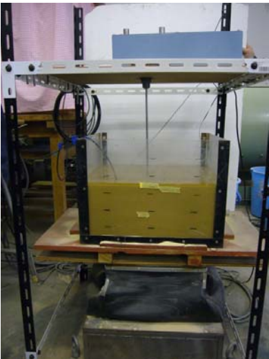
写真-1 振動台実験装置 表-1 実験条件
