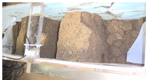
写真 2 破壊後の土層
