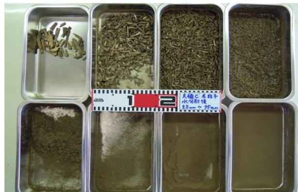
写真-1 津波堆積土を水分別した後の粒径別木粒子
