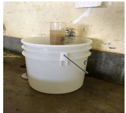
写真2 粒度試験（沈降分析）
