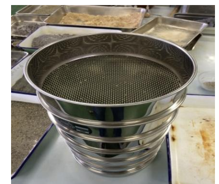
写真3 粒度試験（ふるい分析）
