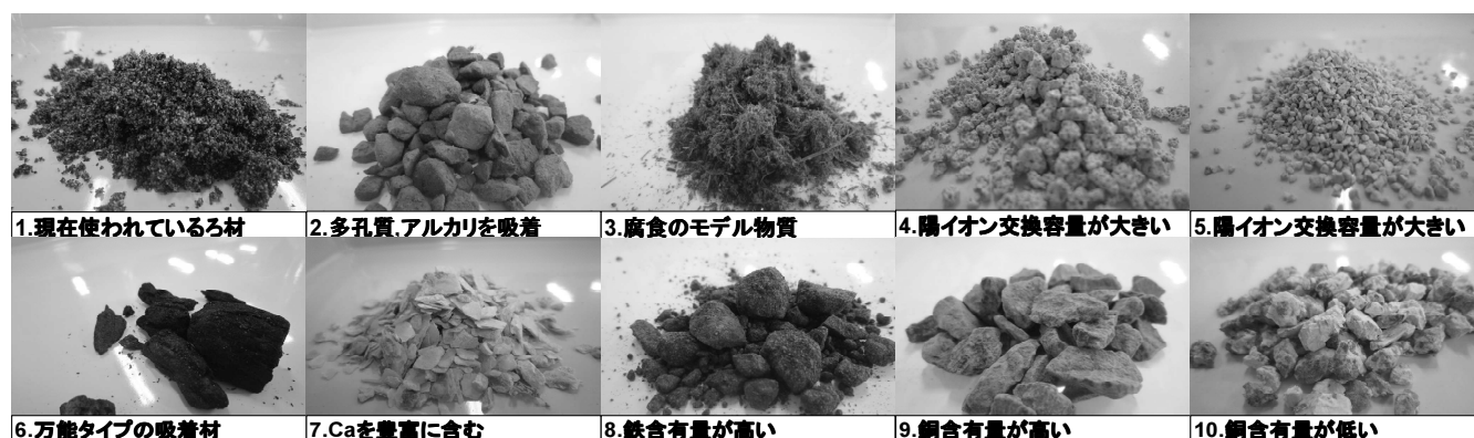
写真-1 本実験に用いた10種類のろ材とその特長。 1. 砂 2. 珪藻頁岩 3. PEATMOSS 4. ケイ酸カルシウム 5. ゼオライト 6. 炭 7. カキ殻 8. 転炉スラグ 9. 玄武岩 10. 花崗岩
