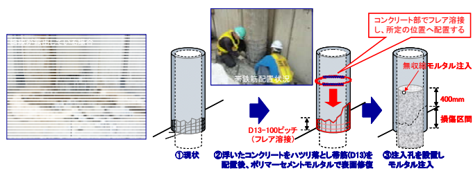
図-3 復旧ステップ図の一例
