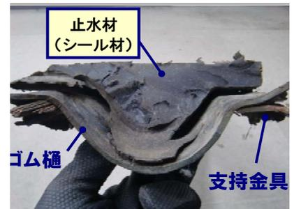
写真-3 伸縮装置の止水材断面
