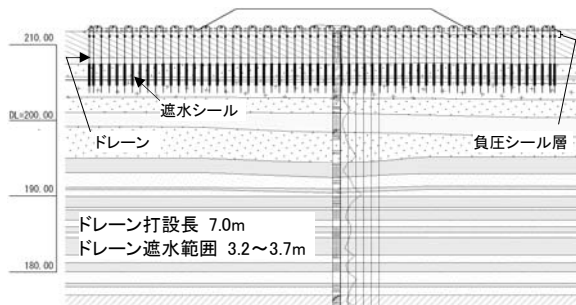
図-4 第2工区 (真空圧密ドレーン工法)
