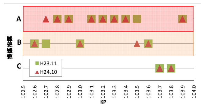
図-6：FWD 損傷指標の経年変化
