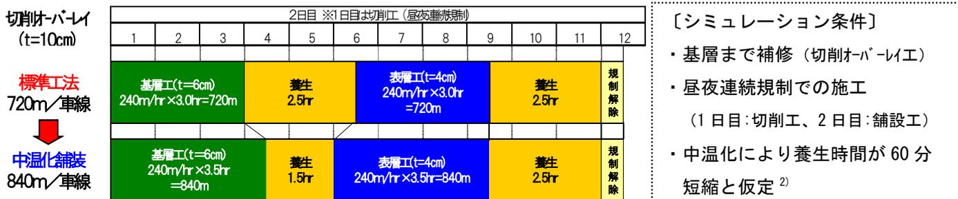
図-2 中温化技術による施工能力向上のシミュレーション
