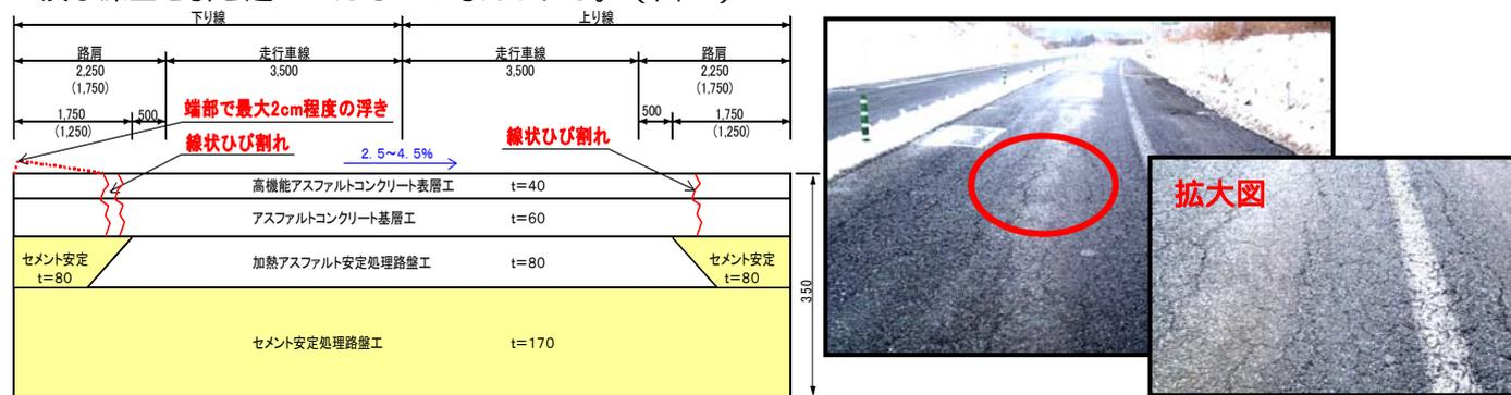
図-1 舗装損傷概略図
