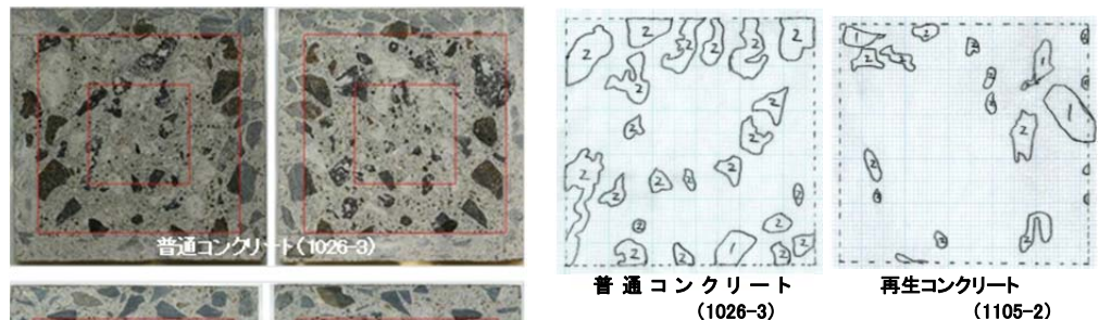
図-4 供試体破断面内の破断種別の一例
