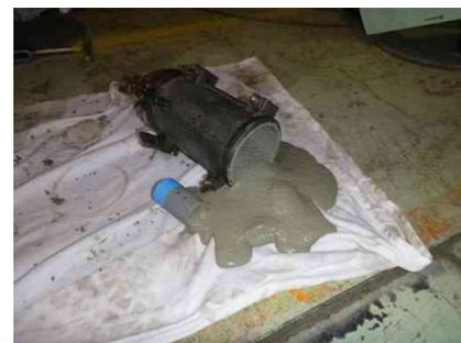
写真-2 材齢 1h のモルタル (材料 A)
