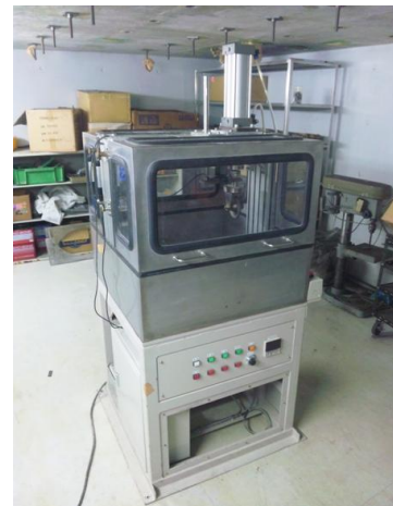
写真-1 小型輪荷重走行 試験装置
