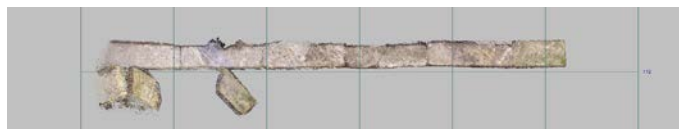
図-1 3Dレーザー測量結果（右岸暗渠延長上の縦断面図） 堤防の管理道路路面と悪水吐暗渠の右岸底板より3段目（天端）との高低差は約3.3m。地中探索を行える深さ。
