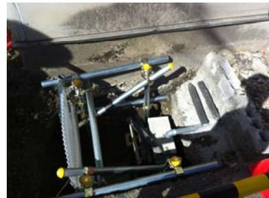
写真1 雨水浸透柵実験装置
