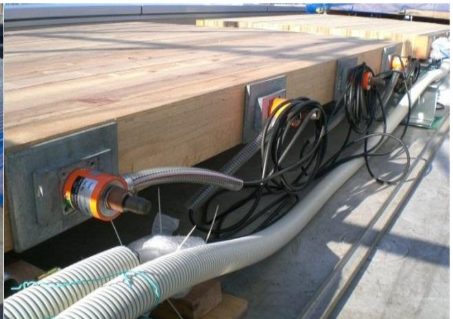
写真2 ロードセル設置風景
