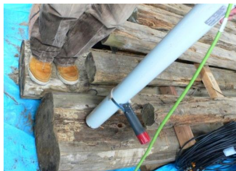
写真 2 レジストグラフによる実験風景
