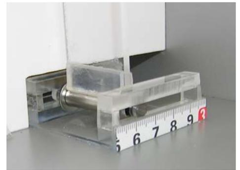
写真-3 ローラー支点的の構造
