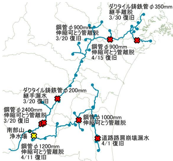
図1 宮城県仙南・仙塩広域水道の被害と復旧
