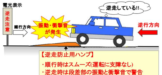
図-2 ハンブを用いた逆走防止装置の概念
