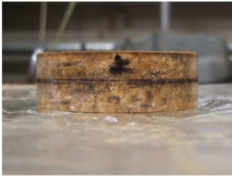
写真-2 アクリル製リングを持ちいた供試体の作製
