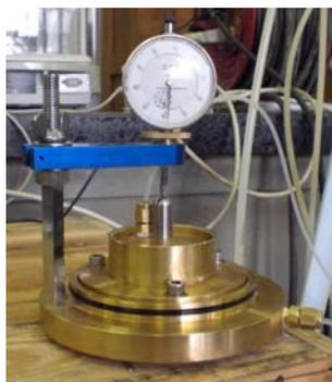
写真-1 真空圧密試験容器
