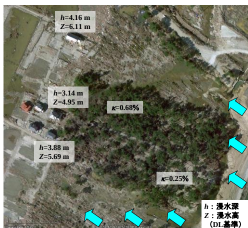
図-7 海岸林の津波減勢効果例 (仙台市東浦. 海岸林幅 140 m, 奥行き 220 m) (Google Earth)
