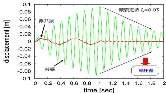
図-4 時刻歴変位応答 (軸方向)
