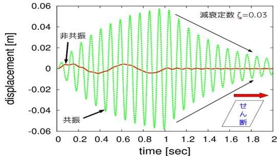
図-3 時刻歴変位応答 (せん断方向)
