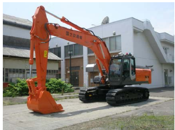
写真-2 空輸対応型油圧ショベル(1.0m3級)全景
