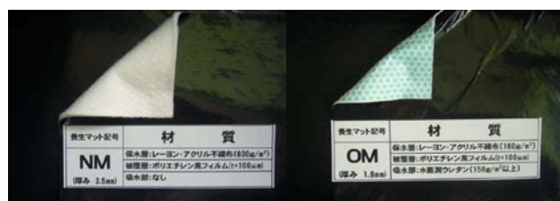
写真-1 NM(新)、OM(旧)湿潤養生マット
