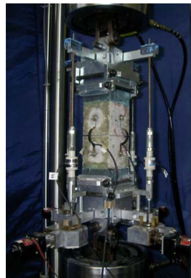
図-1 直接引張試験の状況
