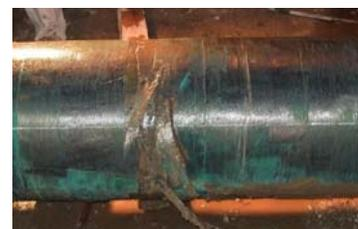
写真-1 CFS の破断 (高強度 RC 杭体)
