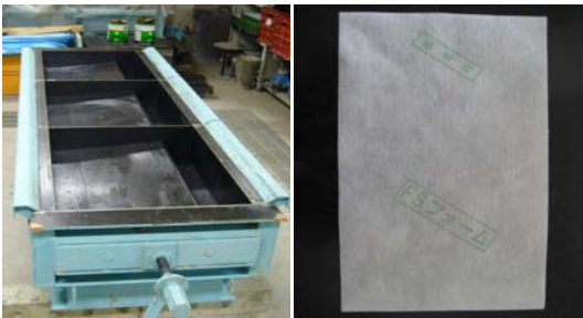
写真-1 L型側溝用透水型枠と透水性シート
