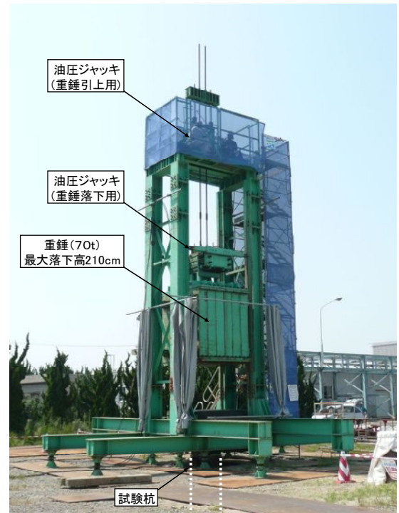
図 1 急速載荷試験(重錘落下装置)
