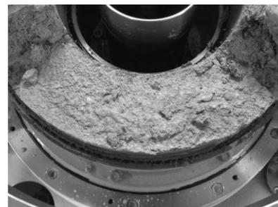
写真-4 試験後のせん断面
