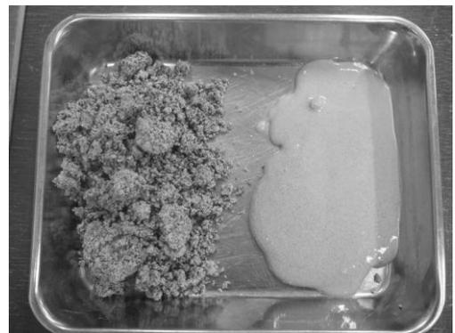
写真-2 試料の自然含水状態での練返し状況
