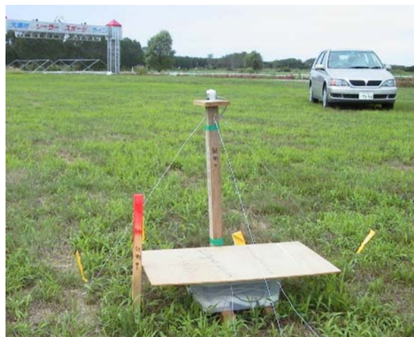
図2 太陽光強度センサー設置状況
