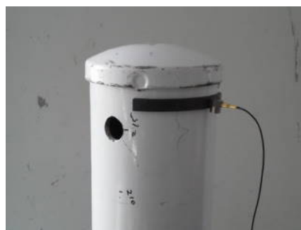
写真1 受振子設置例
