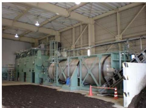
写真-1 発酵処理装置
