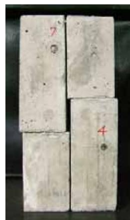
写真 1 . せん断破壊状況
