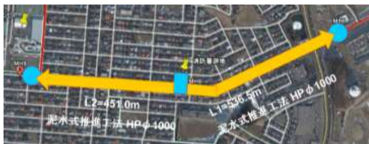
図 - 1 二方向同時推進区間
