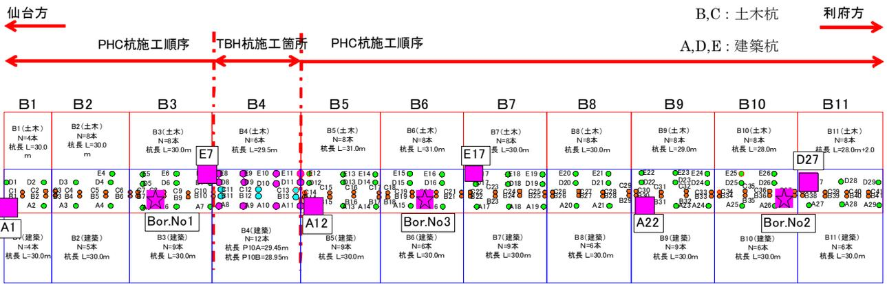
図-4 試験杭施工箇所一覧
