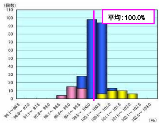
図-4 現場での締固め度
