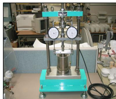
図2 膨潤圧試験の実施状況
