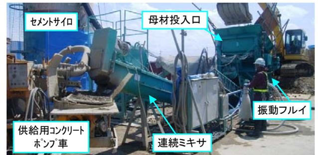
写真-1 現場に設置した仮設プラント
