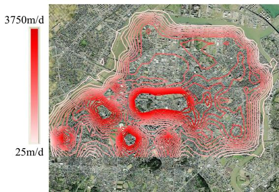
図-4 浸透流解析結果
