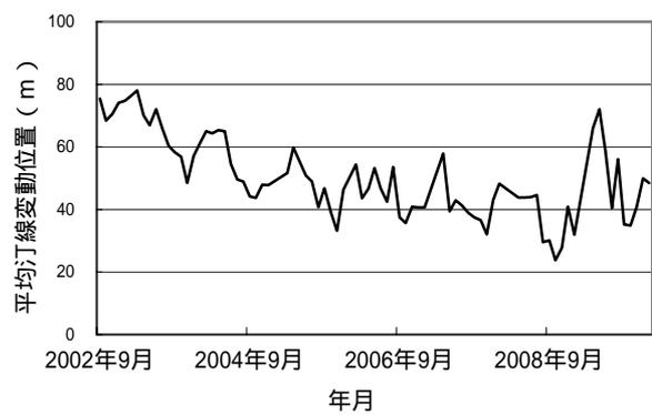
図6 B13 ヘッドランド工北側の平均汀線図
