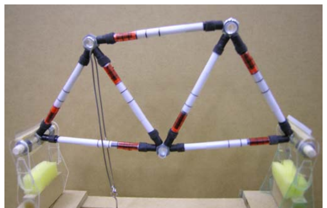
写真 3 トラスの変形
