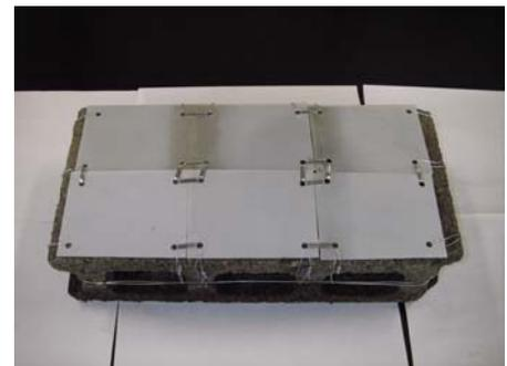
図-4 コンクリートブロック+人工付着板
