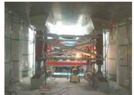
写真-2 水平反力載荷装置
