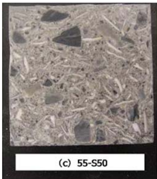
図-2 貝殻粗骨材を用いたセメント固化体の断面
