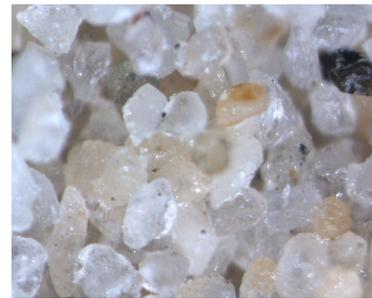
図 4 セメントを微量加えた豊浦砂の写真 (80 倍)
