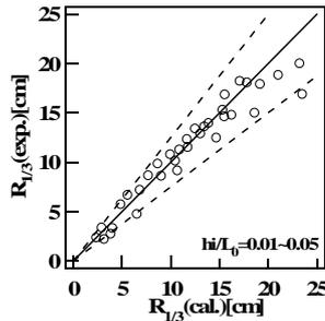
図-5  $R_{1/3}$  の実験値と計算値の比較
