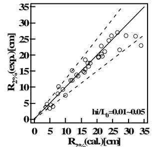
図-6  $R_{2\%}$  の実験値と計算値の比較
