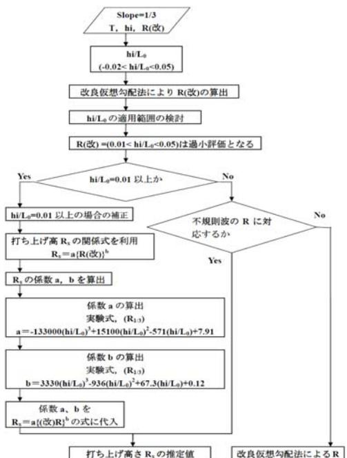
図-7 代表打ち上げ高さの推定フロー
