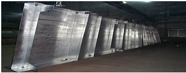
写真-1 鋼 I 桁のねじれ変形
